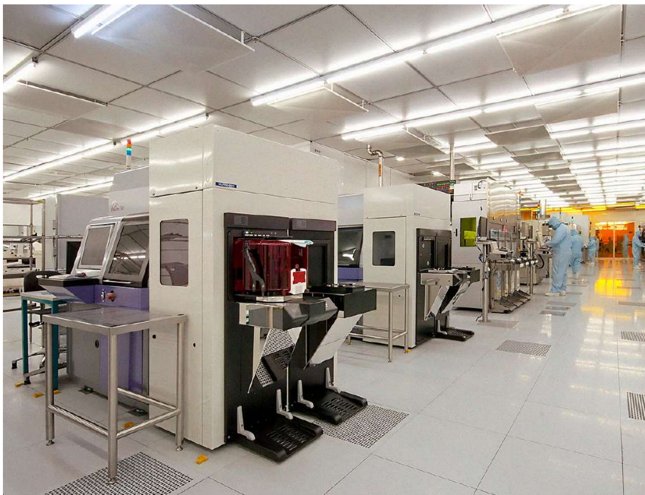
Processos de encapsulamento de semicondutores na ATEP Amkor Semiconductor packaging processes at ATEP Amkor
